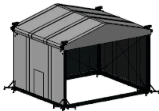
MPT ROOF 12 x 10 m + structure de liaison au sol + allée de son + banches latérales et arrière
